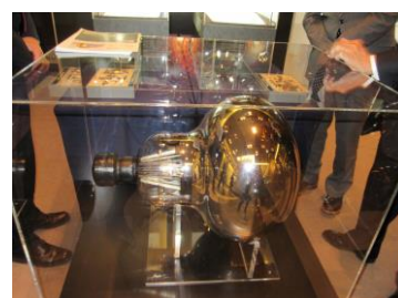
20インチ光電子増倍管/浜松ホトニクス
